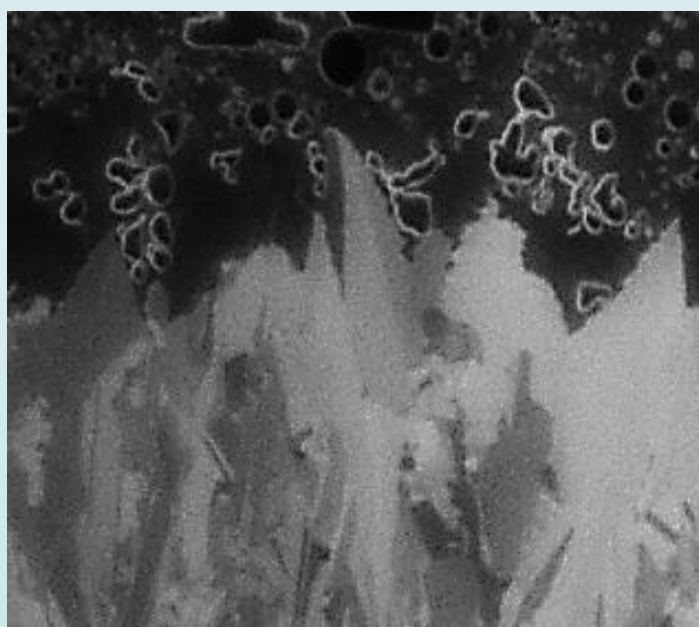
約2倍の面積/表面積比を持つ針状表面の アンカー効果により樹脂密着性を向上
