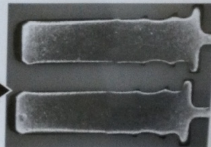
改良Ni 2.0 \mu m / Au 0.76 \mu m 封孔処理あり
