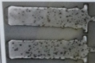
Ni 4.0 \mu m / Au 0.76 \mu m 封孔処理あり
